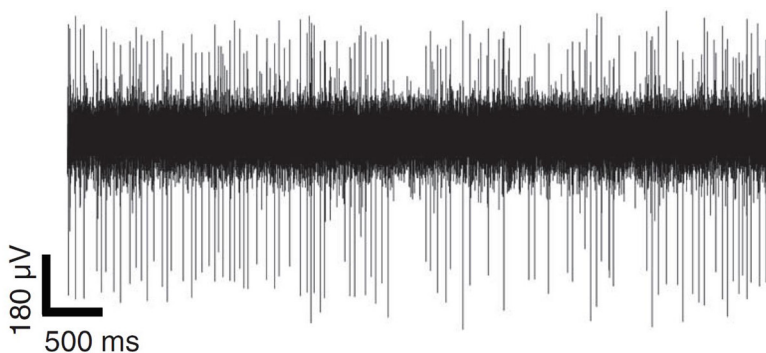
Рис. 11. Внеклеточный электрический сигнал, записанный при помощи платинового микроэлектрода
